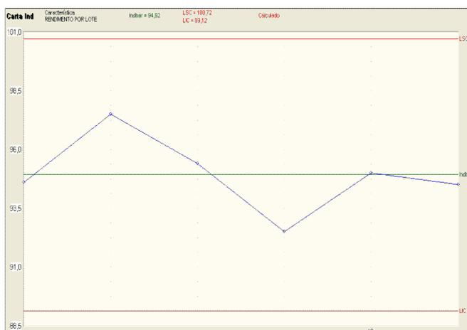
Figura 11: Gráfico de Shewhart – hidroclorotiazida 25 mg comprimidos (4 vias)
