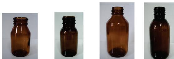
FIGURA 1. Embalagens avaliadas: (a) frasco de vidro 30 mL/24 mm; (b) frasco de PET 30 mL/24 mm; (c) frasco de vidro 120 mL/28 mm; (d) frasco de PET 120 mL/28 mm.
