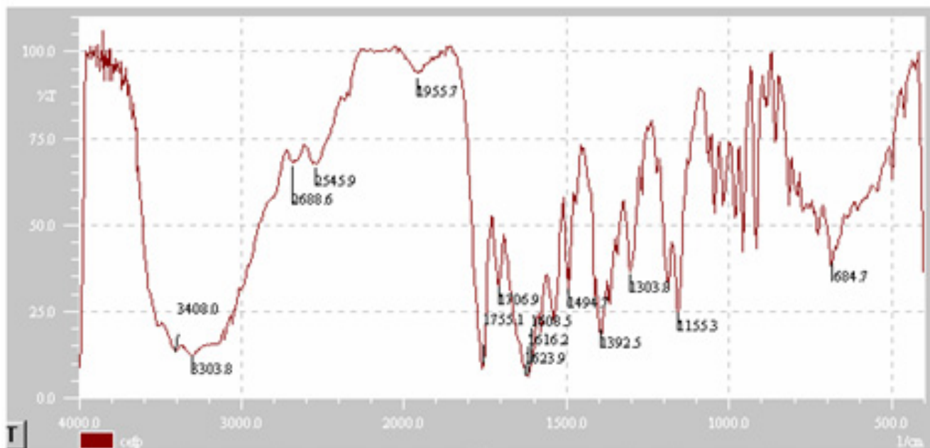
Figura 3. Espectro na região de infravermelho de ceftazidima em pó para solução injetável em pastilhas de brometo de potássio.
