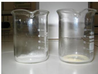
Figura 3. Resultado do Teste de Estresse térmico das dispersões A. Amostra da cana-de-açúcar e B: Derivado de celulose (Carboximetilcelulose).
