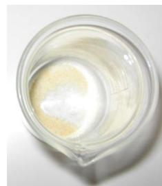
Figura 1. Resultado do processo de Polpação seguido de lavagem com solução metanólica em meio ácido, com adição de ácido monocloroacético.
