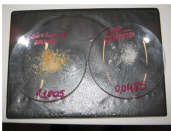
Figura 3.1. Resultado da raspagem do material Precipitado no fundo do béquer após o Teste de Estresse térmico.
