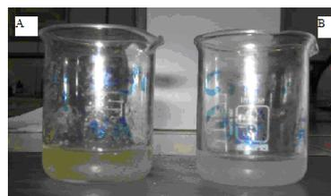
Figura 2. Dispersões obtidas a partir da mistura dos derivados de celulose com solvente (água). Figura 2-A; Amostra (bagaço da cana-de-açúcar) e Figura 2-B; Padrão (Carboximetilcelulose).
