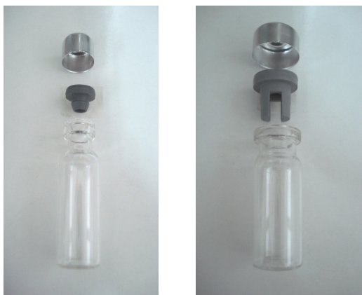
Figura 3. Sistema de fechamento composto por rolha de borracha e anel de alumínio empregado em frascos de vidro tipo I para produtos esterilizados (a) e rolha de borracha com abertura lateral e anel de alumínio utilizada em frascos para produtos liofilizados (b).
