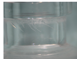
Figura 5. Exemplo de microfissura localizada abaixo do anel da termina o do frasco de vidro tipo I de 13 mL/13 mm. Imagem obtida em estereomicrosc pio, com aumento de imagem de 18 vezes.
